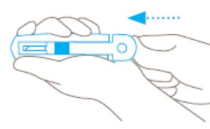
Disporre la lama **esattamente sulla camma** e chiudere il portalama verso l'alto. Rimettere l'inserito di plastica nell'impugnatura. **Attenzione:** non tenere mai la mano davanti all'estensione della lama!
