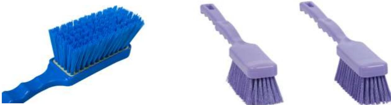
Gli articoli resinati sono fabbricati con una tecnica unica al mondo: i fasci di setole vengono fissati al corpo prima con delle graffette in acciaio inox e poi viene iniettata la resina all'interno e attorno delle setole in modo da prevenirne lo sfilamento delle stesse e impedire allo sporco e ai batteri di depositarsi.
